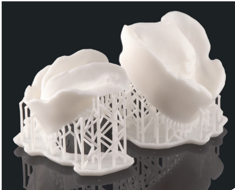
Abb. 1 3-D-gedruckte Löffel mit Bisswällen.
