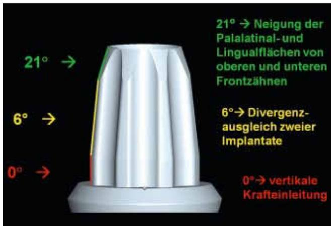
Abb. 4: Multifunktionelles, trajektorielles Retentionselement von nur 4,2 mm Höhe und 50/60 mm<sup>2</sup> Oberfläche
